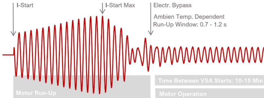
Die Anordnung der geschalteten NTCs ist in ihrer Funktion ein Vollwellen-Sanftanlasser, also ohne jegliche Oberwellenbelastung durch Phasenanschnitt. Dadurch kann der VSA ohne Zusatz in die bestehende Verdrahtung eines An/Aus Klimageräts integriert werden.
